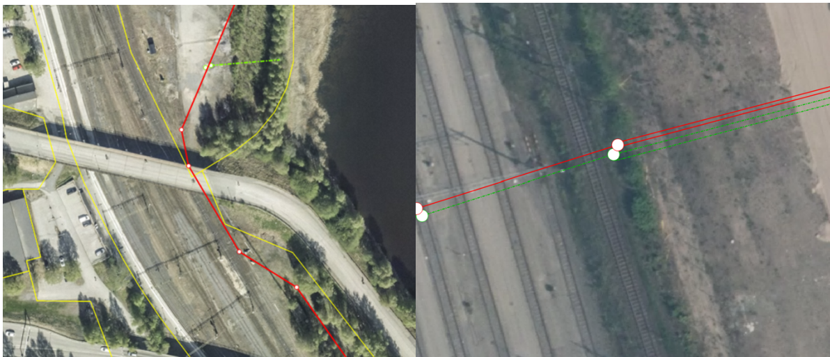
Figur 1. Bild till vänster: Spillvattenledning S800 som behöver flyttas. Bild till höger: 2st brunnar som behöver rivas
