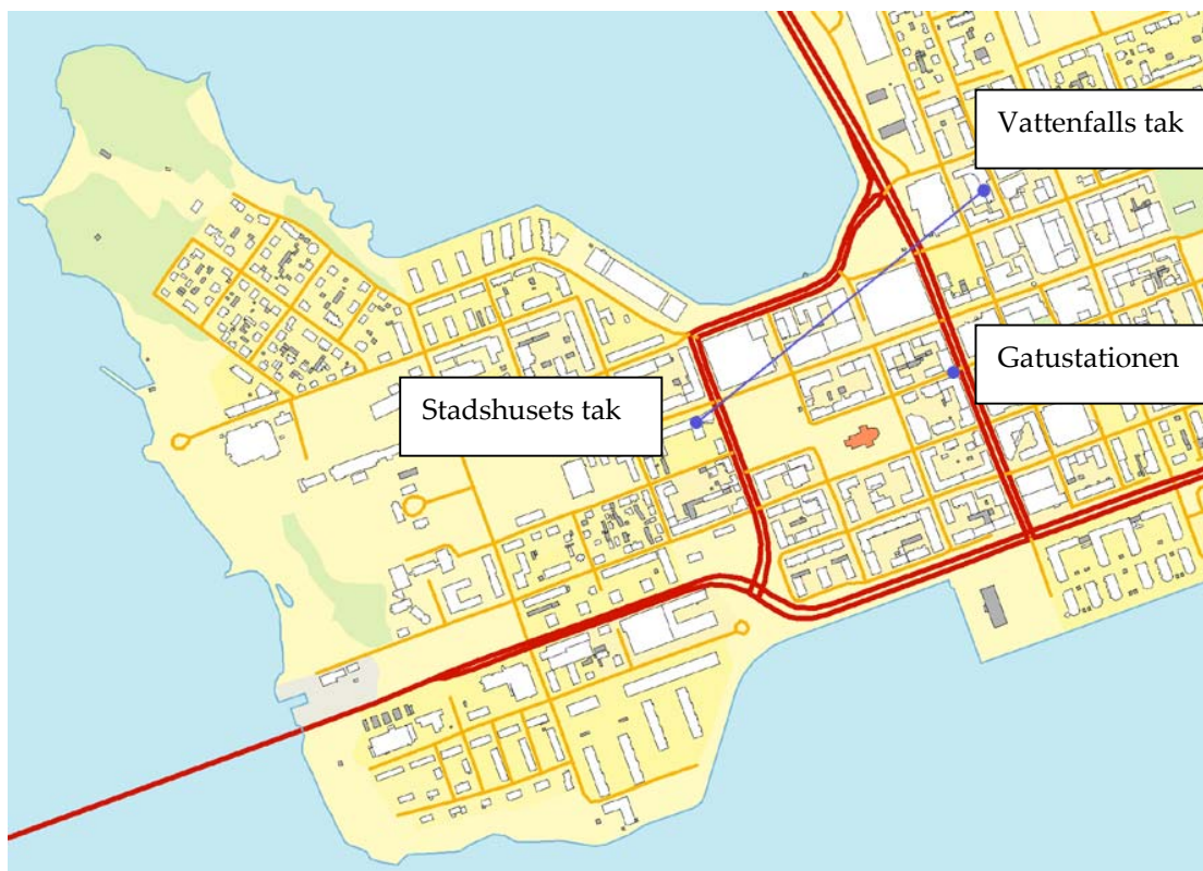
Figur 2. Bilden visar var de olika mätstationerna är placerade i Luleå. I taknivå mäts luftföroreningar som kvävedioxid, svaveldioxid och ozon med hjälp av DOAS-tekniken. I gatustationen mäts kvävedioxid och partiklar PM10 med hjälp av en NOX-monitor och ett \beta -strålinstrument.
