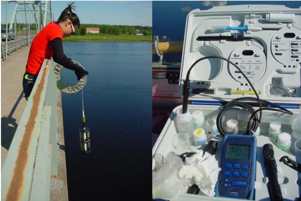
Figur 3. Till vänster ses provtagning med Ruttnerhämtare, till höger mätning av pH, syrehalt och konduktivitet med fältmätutrustning.
