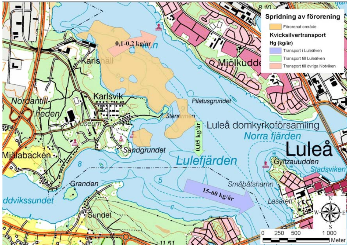
Figur 23 Redovisning av spridning av kvicksilver från förorenade sediment till resterande del av Notviken samt från Notviken ut till Lule älv. Som jämförelse redovisas även beräknad transport i Lule älv (data hämtat från SLU, 2006).
