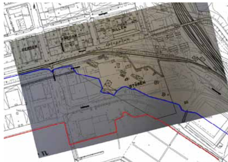
Jämförelser mellan strandlinjer. Den blå linjen visar strandlinjen 1927 och den röda visar strandlinjen idag. Bild hämtad ur: PM-Geo- och miljögeoteknik, Tyréns, 130703
